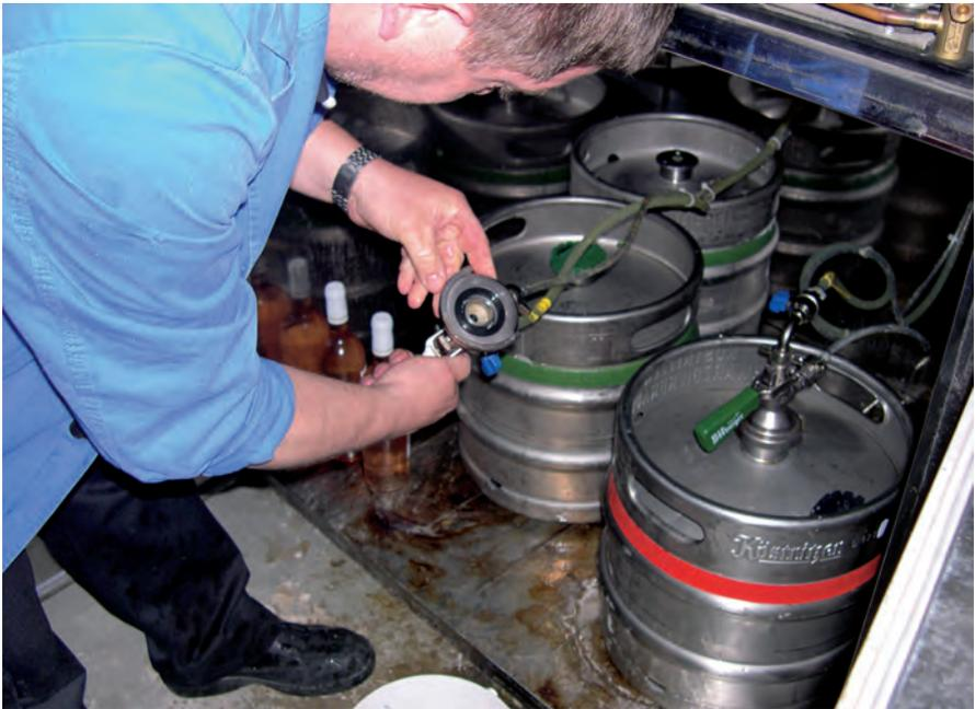
Abb. 3: Reinigung des Leitungsanschlussteiles
